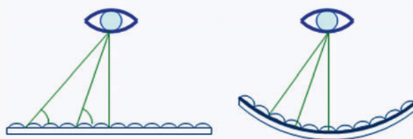
Рис. 1. Изменение угла наблюдения растрового 3D-экрана — обычного плоского (слева) и вогнутого (справа)
